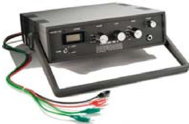
TCM-03は、施設内に残された電話、コンピュータ、電気等の不要配線や機器増設用の予備配線、及び使用中の配線に仕掛けられた盗聴機材の発見用の高性能ケーブル試験装置として、ケーブル上に流れる不審信号の検出及び盗聴器の動作時の電圧変化を測定します。
