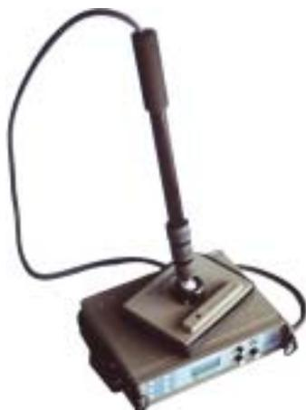
スーパーブルームは、最新型のノン・リニア・ジャンクション(NLJD 非線形金属交差)検出機能を持つ盗聴発見器で、アンテナ先端部のレーダー波送受信機を用いて、埋設された半導体回路や無線発信機等を通電・非通電の区別無く検知及び所在の特定を行います。
