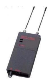
デルタ V ECM は、室内で発信している盗聴電波 を二本のアンテナで捕らえ、それぞれのアンテナ間 の電界強度の差異検出を行い、無線発信機等の検 知及び所在の特定を行います。
